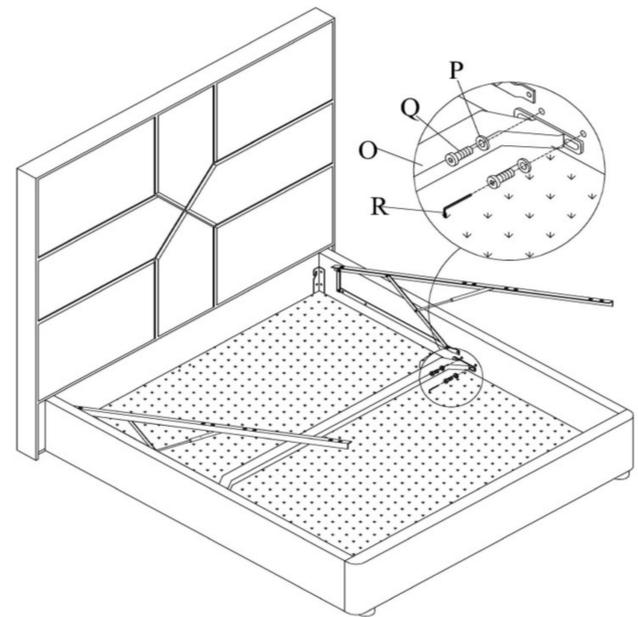
\*Le boulon (Q) et la rondelle (P) sont fixés aux barrières latérales, veuillez les retirer avant d'installer.\*
