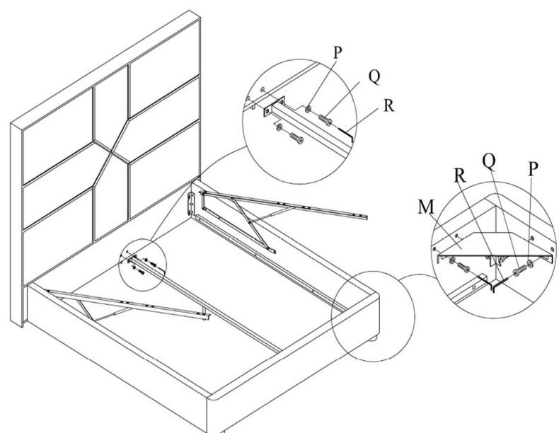
\*Le boulon (Q) et la rondelle (P) sont fixés à la tête de lit, aux côtés de lit et au pied de lit, veuillez les retirer avant l'installation.\*
