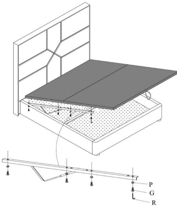
\*Le boulon (G) et la rondelle (P) sont fixés à la plinthe, veuillez les retirer avant d'installer.\*
